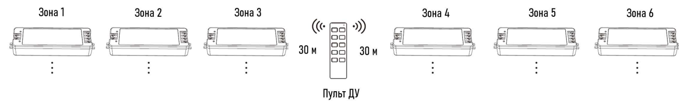
Рисунок 3. Разветвленная система управления с многозонным пультом ДУ
