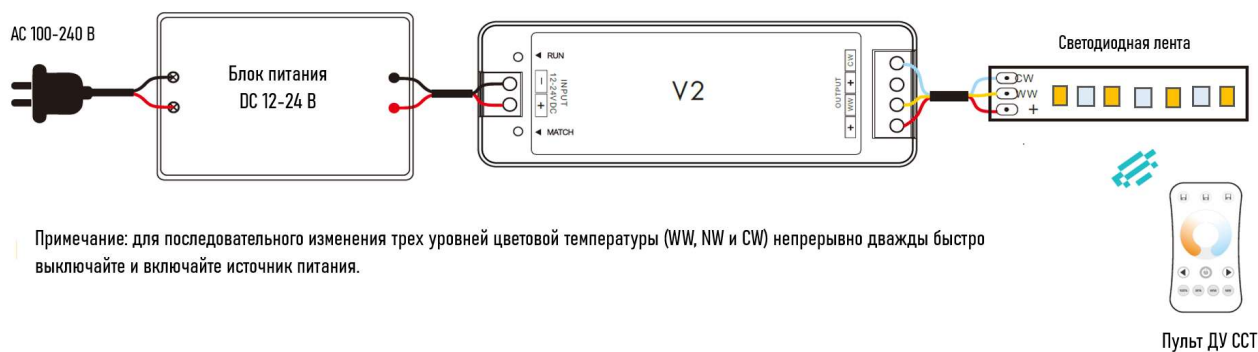
Рисунок 1. Схема подключения контроллера
