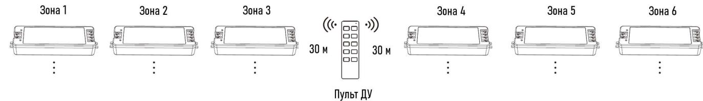
Рисунок 3. Разветвленная система управления с многозонным пультом ДУ
