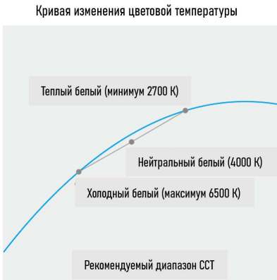
Рисунок 2. Кривая изменения цветовой температуры и кривая диммирования
