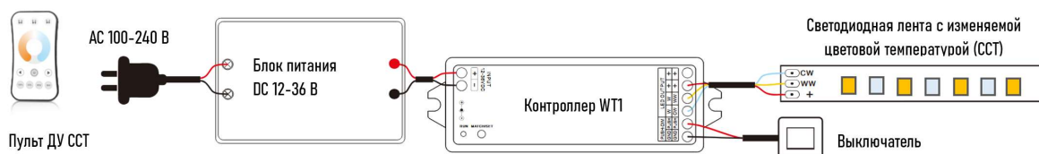
Рисунок 4. Схема подключения контроллера со светодиодной лентой с изменяемой цветовой температурой
