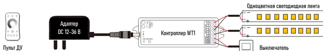
Рисунок 3. Схема подключения контроллера с одноцветной светодиодной лентой
