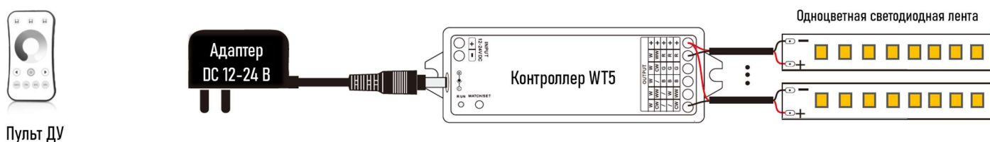
Рисунок 7. Схема подключения контроллера с одноцветной светодиодной лентой
